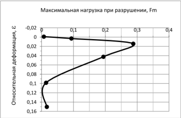
График зависимости деформации от приложенной нагрузки ε=f(F)
