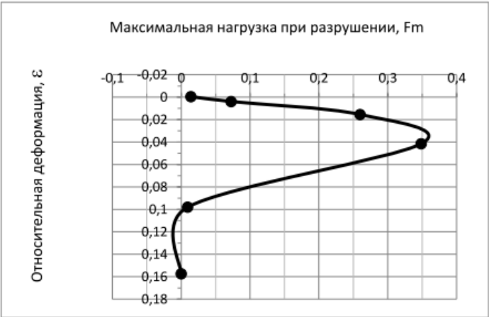
График зависимости деформации от приложенной нагрузки ε=f(F)
