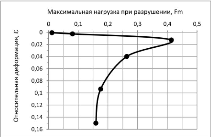
График зависимости деформации от приложенной нагрузки ε=f(F)
